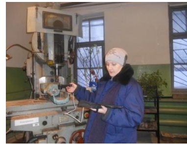
Измерение освещенности в ремонтно-механической мастерской
