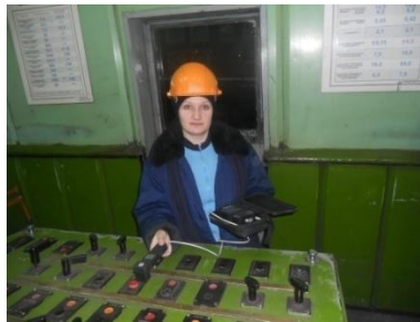
Измерение освещенности в пульте управления агломашиной на аглофабрике
